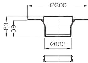
**Aufsatzelement mit Muffe**
